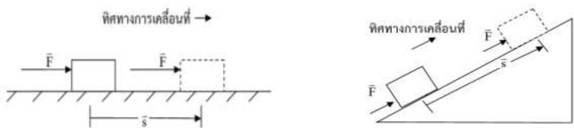
รูปที่ 1 รูปแสดงการออกแรง \vec{F} ผลักวัตถุบนพื้นราบและพื้นเอียง
