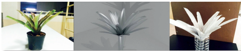
▲ ภาพที่ 5 แผ่นอะลูมิเนียมมาตัดให้เป็นรูปร่างเหมือนสับปะรดสี
